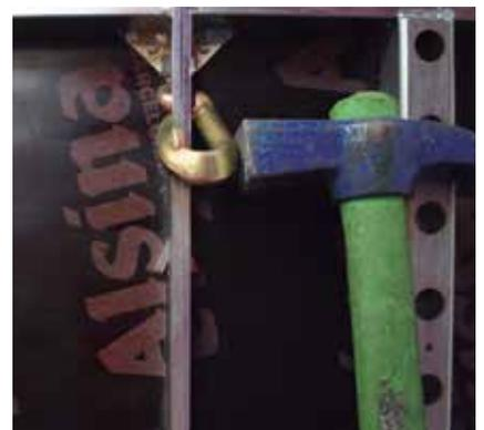
El Clip unión, está diseñado para permitir su fijación sólo con el empleo de martillo, sin necesidad de que el operario use herramientas especiales.
