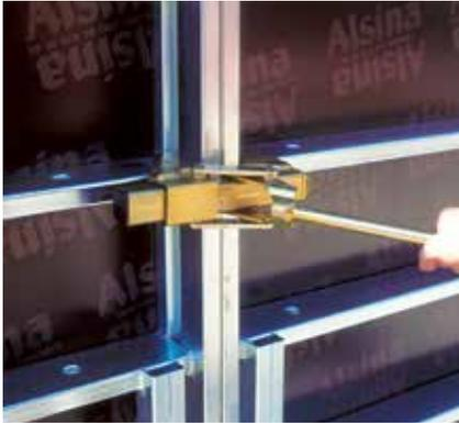
La unión y alineación de los paneles se realiza mediante la Grapa GR-2, cuyo diseño permite unir y alinear los paneles con una sola mano y sin herramientas. Admite la Grapa GR-2 Extensible, para suplementos de hasta 26 cm de ancho.
